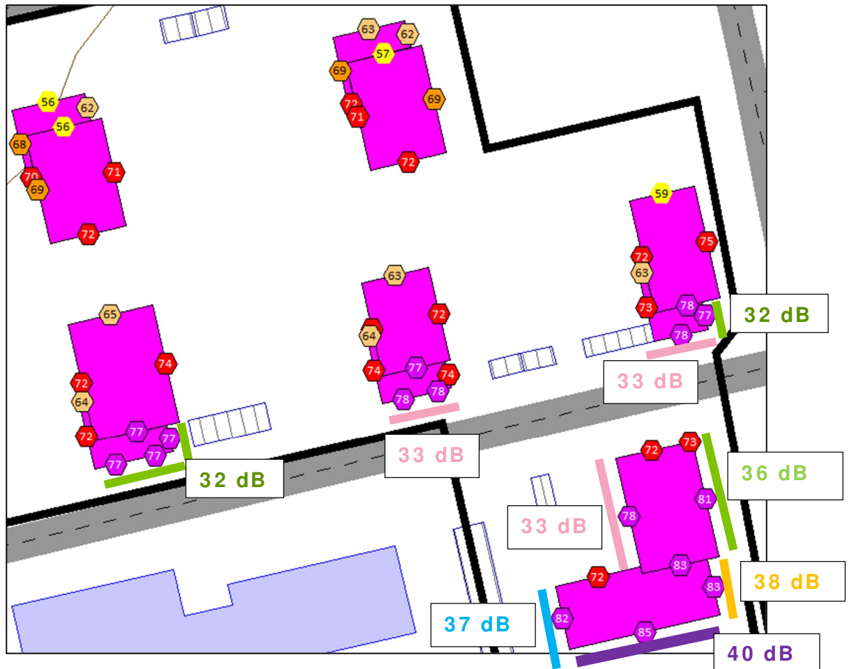
Kuva 22 Julkisivuille kohdistuvat ääneneristävyysvaatimukset enimmäisäänitasojen LAF_{max} perusteella vaiheessa 2. niiltä osin, kun minimivaatimus 30 dB ylittyy.
