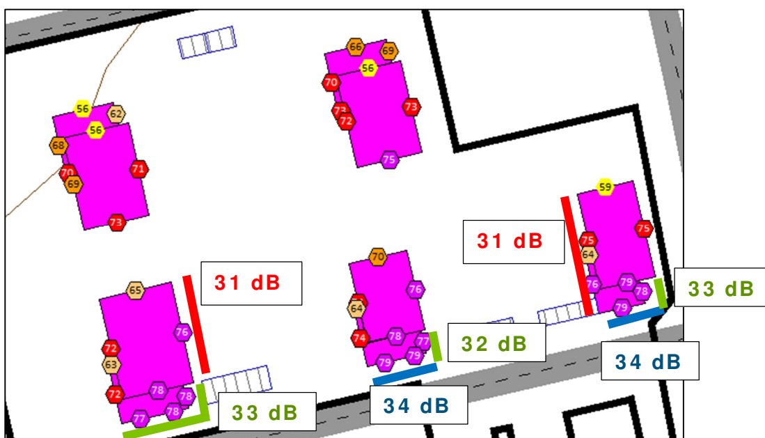
Kuva 21 Julkisivuille kohdistuvat ääneneristävyyksivaatimukset enimmäisäänitasojen LAF_{max} perusteella vaiheessa 1. niiltä osin, kun minimivaatimus 30 dB ylittyy.
